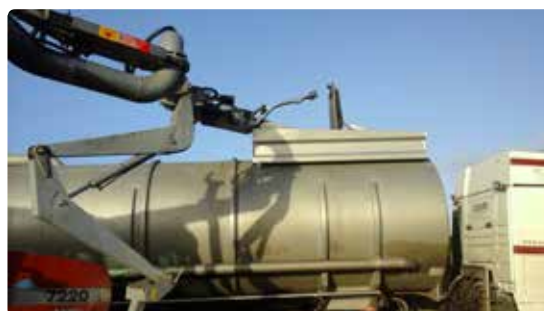
Monteret kamera til overvågning af gylleopfyldning i tanktrailerens.
